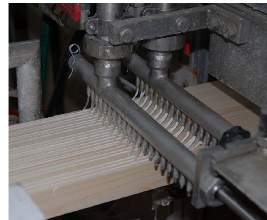
Das Gamser Unternehmen Hausbau Schöb verarbeitet Bergmondholz zu Häusern. In den Werkhallen werden moderne, rationelle Fertigungsanlagen eingesetzt. Links: Auftragen des Leims in der Herstellung von Leimbändern. Rechts: Die Produktion der Bauelemente erfolgt weitestgehend mittels EDV-gesteuerter Automaten.
